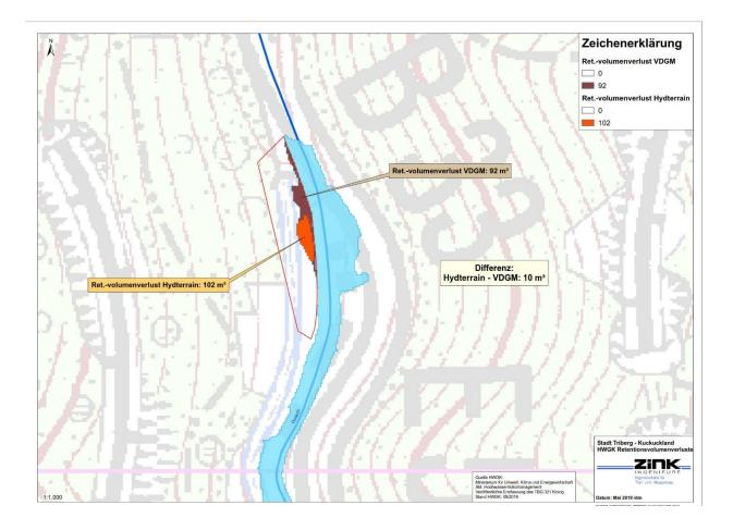
Der Ausbau und die Aufwertung der linksseitigen Uferbereiche rufen zwischen den Gewässerkm 16 + 337.10 und 16 + 400.73 einen Retentionsvolumenverlust in Höhe von ca. 102 m³ hervor.
